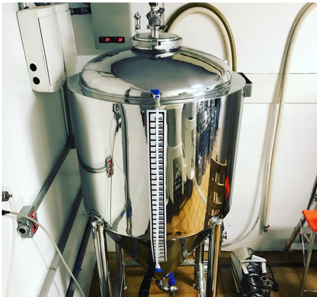
Figura 5: Fermentador de 30L da cervejaria perdizes.
