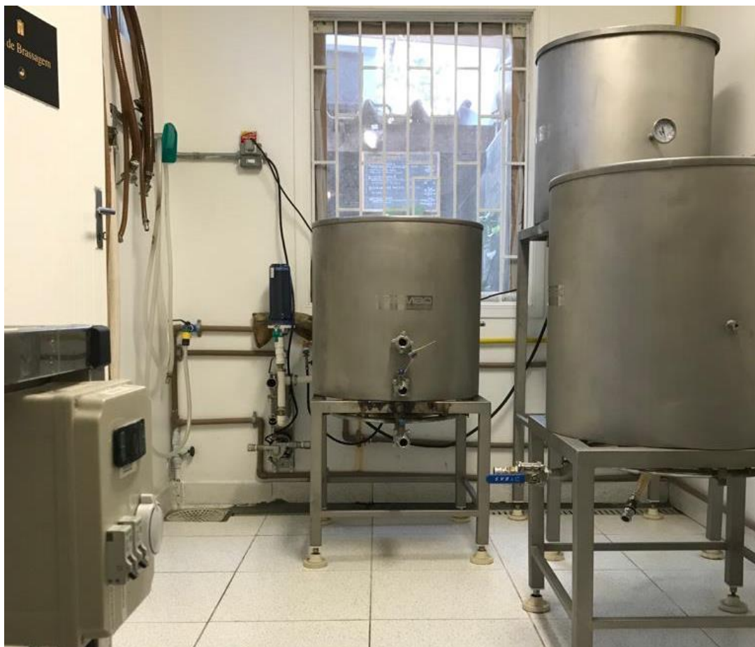
Figura 4: Sala de brassagem da Cervejaria Perdizes, na imagem é possível observar as panelas em que é realizado o cozimento da cerveja.
